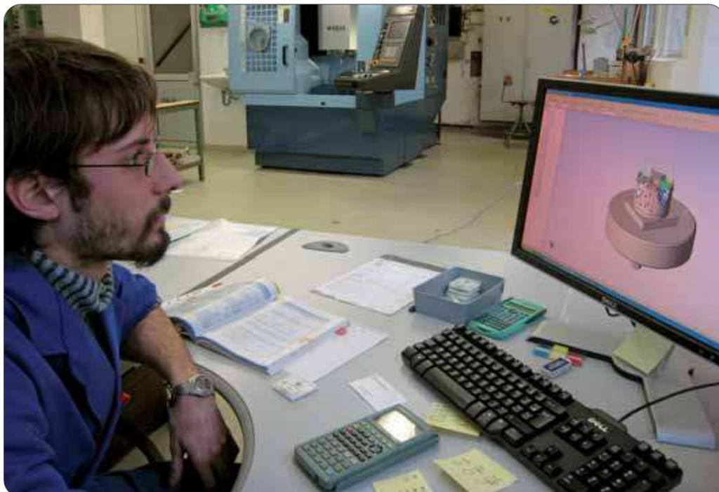
Depuis son poste, Tristan peut lancer le programme de contrôle de la pièce avec le logiciel Blum. Avec une précision de l'ordre de  $3\mu$  dans son volume, entièrement contrôlé thermiquement, la machine joue le rôle d'une tridimensionnelle.
