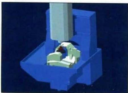
La LXo de Matsuura est conçue comme un "vrai" 5 axes avec un bâti surdimensionné. Source : Vuichard.
