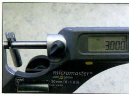
L'usinage en 5 axes continu permet d'obtenir une forme de tri lobe parfaitement cylindrique sur toute sa hauteur et la qualité géométrique de la machine permet d'être à quelques microns de la cote nominale. Source : Vuichard.
