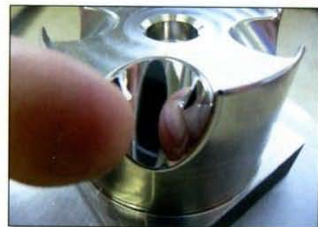
Pièce poli miroir réalisée manuellement après usinage 5 axes continu sur du K107 de Böhrler à 60 HRC. Les déplacements de machine à 0,0001 µ permettent des états de surface exceptionnels. Source : Vuichard.
