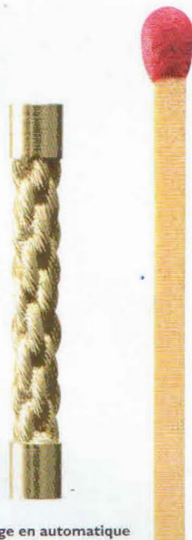
Vingt heures d'usinage en automatique ont été nécessaires à cette réalisation.
